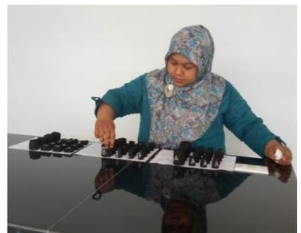
Penyusunan sampel setelah dicetak untuk dilakukan pengeringan
