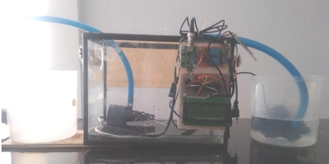
Lampiran 1. Gambar pada saat sebelum pengujian alat kendali kadar pH air kolam renang outdoor
