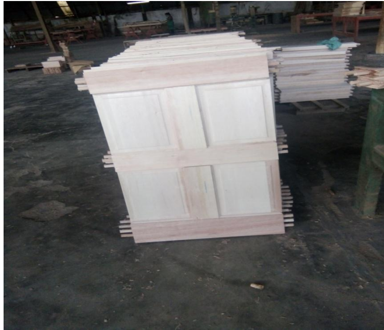
Kondisi kayu setelah perakitan
