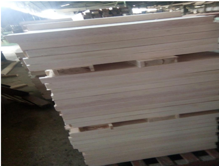
Kondisi kayu setelah pengeleman
