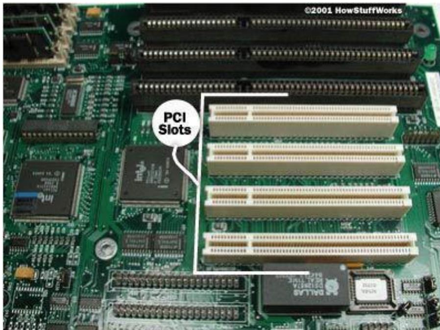
**Gambar 16.** Slot PCI (<http://tokoempatsaudara.files.wordpress.com/>)
