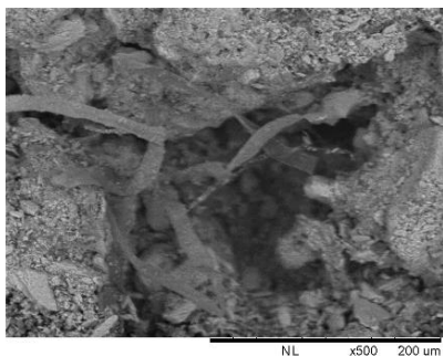
Gambar 4.5 Hasil Foto SEM Sampel papan Gypsum: (a) Perbesaran 500x; (b) 250x
