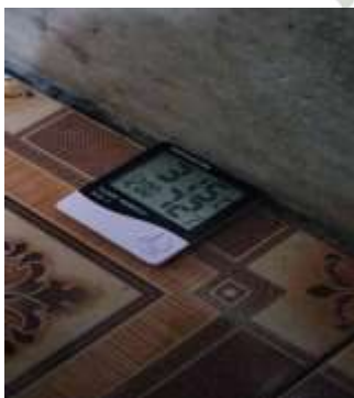
Gambar 5 Pengukuran Suhu dan Kelempaban
