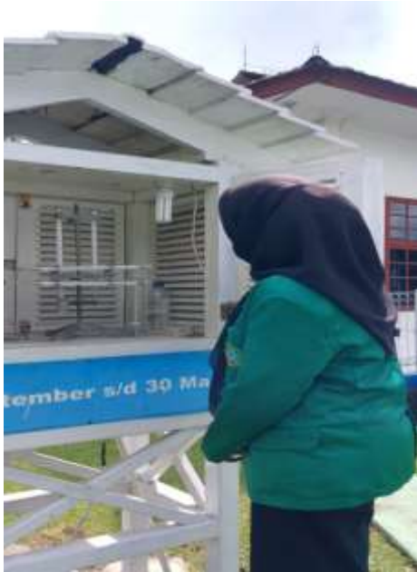
Gambar 1. Pengukuran Suhu dan Kelembaban Dengan Thermohygrometer
