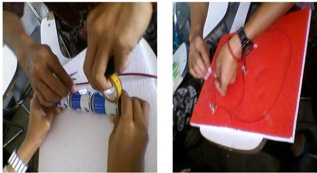
**Gambar : Proses pembuatan rangkaian seri (kiri) dan rangkaian paralel (kanan)**
