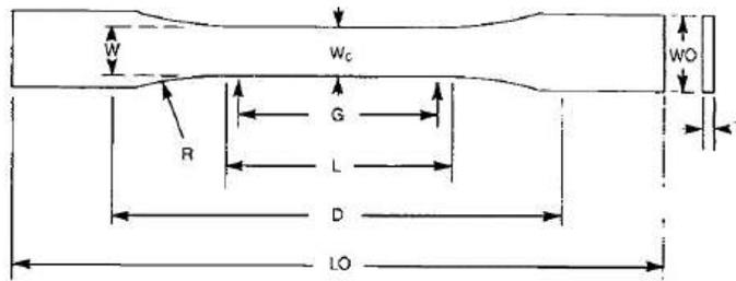
Gambar 2.8 Spesimen Uji Tarik
