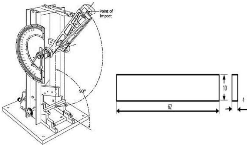
Gambar 2.10 Spesimen Uji Impak
