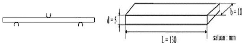
Gambar 2.9 Spesimen Uji Lengkung
