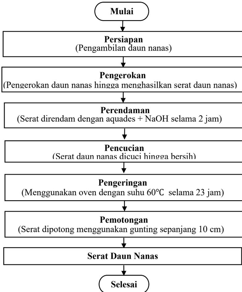
Gambar 3.1 Diagram Alir Tahap Preparasi Daun Nanas
