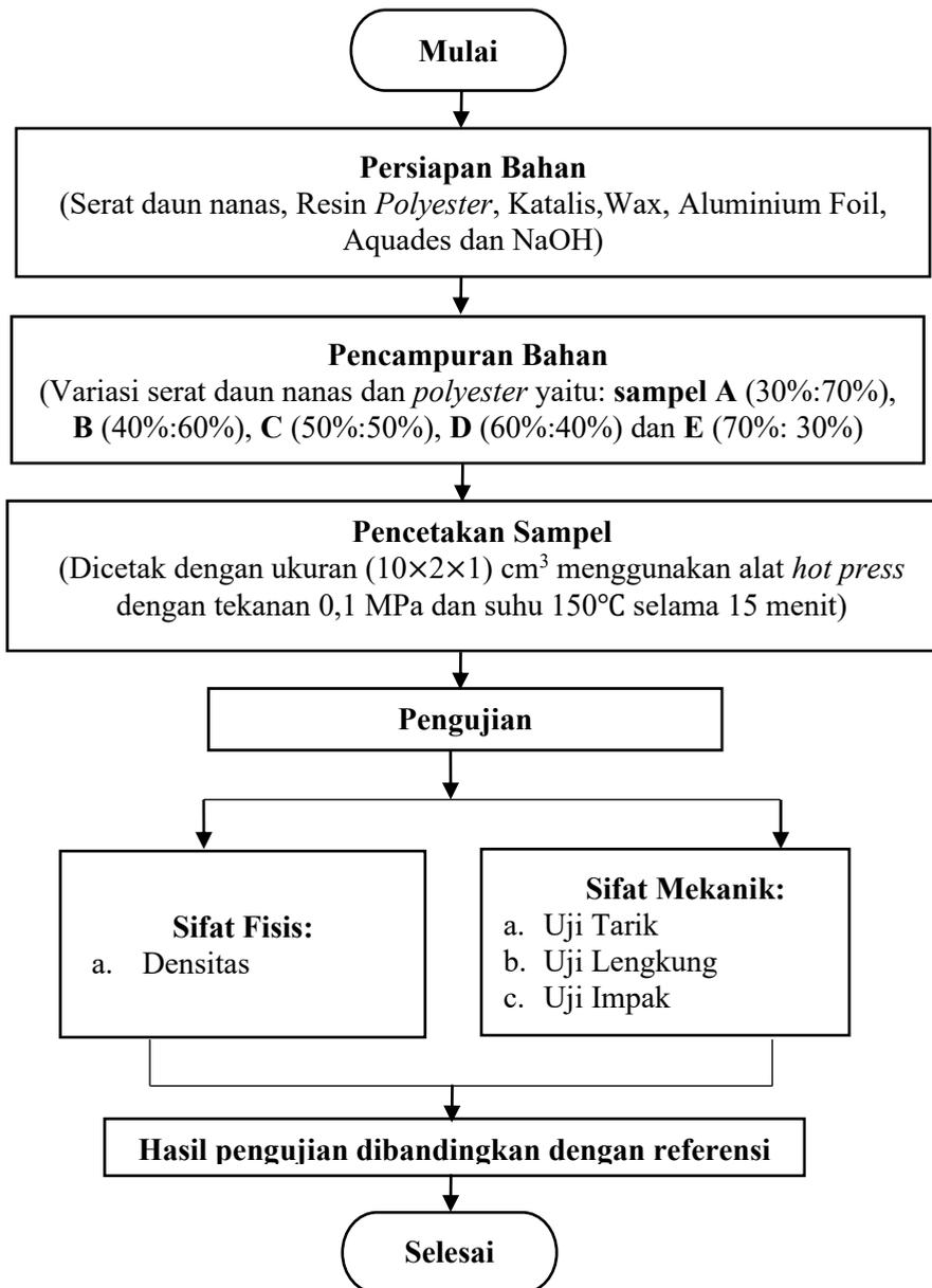
Gambar 3.2 Diagram Alir Tahap Pembuatan dan Pengujian Sampel Material Komposit
