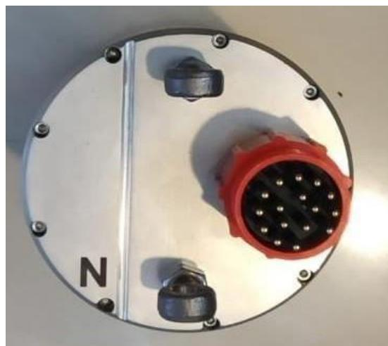
Letakkan sensor dengan garis menunjuk ke arah utara sejati (gunakan *gps portable* atau kompas geologi )
