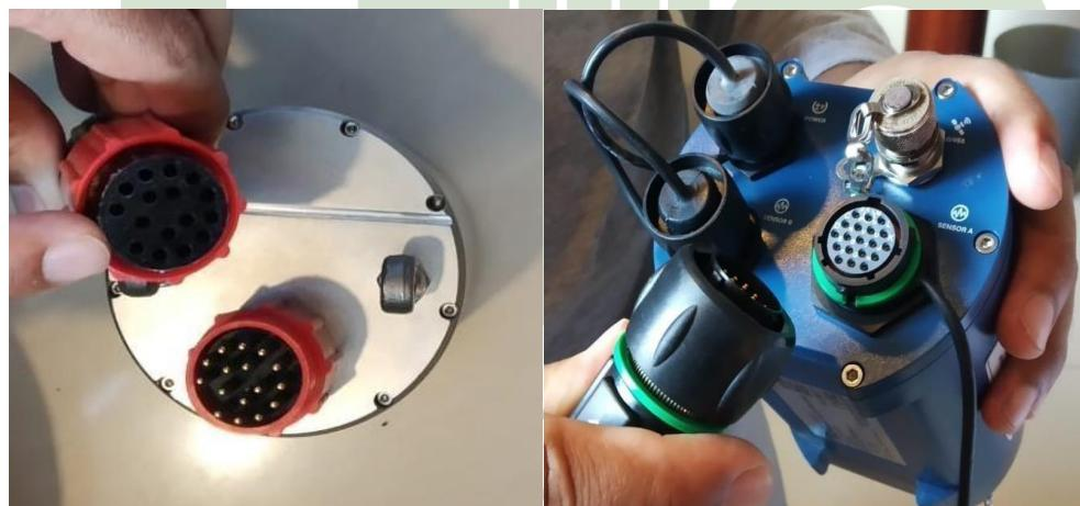
Hubungkan sensor dan *Digitizer* dengan kabel konektor sensor *to digitizer*. Warna merah untuk sensor dan warna hijau untuk digitizer
