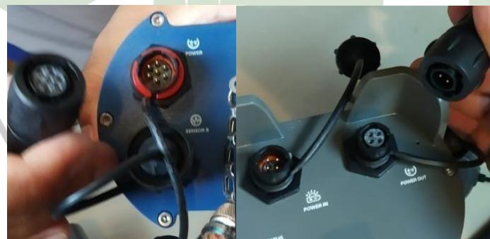
Hubungkan sensor dan *Battery* (pilih *power out*) dengan kabel *power*, setelah sensor dan *battery* terhubung maka waveform akan otomatis terekam dalam *digitizer*.
