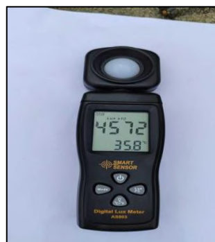
Gambar 4.2 Pengukuran intensitas cahaya menggunakan lux meter pada jam 14.00
