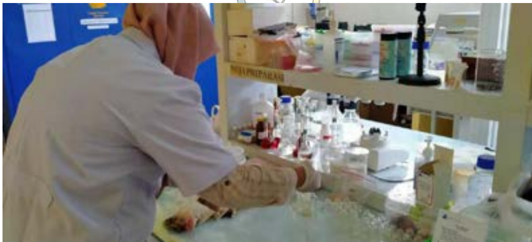
Gambar sampel yang sudah di beri 5 tetes reagent test kits boraks
