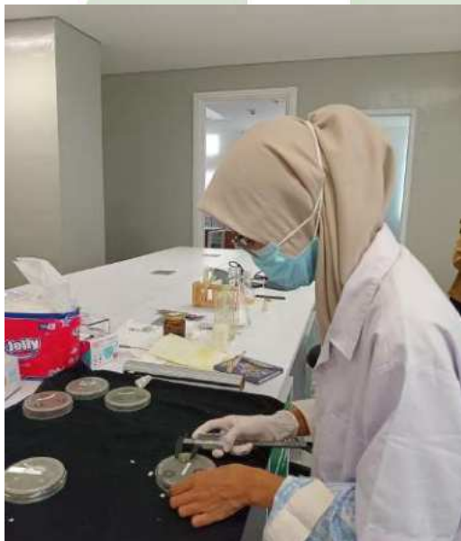
Diukur zona hambat bakteri menggunakan jangka sorong digital
