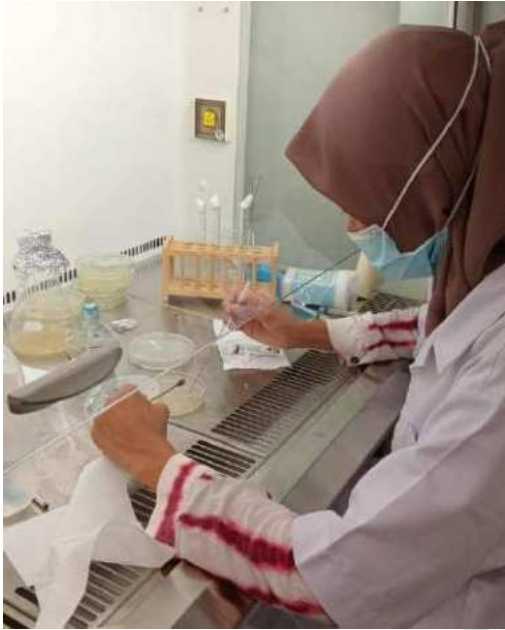
Dimasukkan salep ekstrak etanol cengkeh kedalam lubang sumuran sesuai konsentrasi masing-masing
