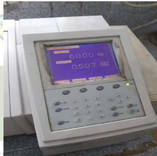
Pengukuran Mc. Farland 0.5 dengan spektrofotometri
