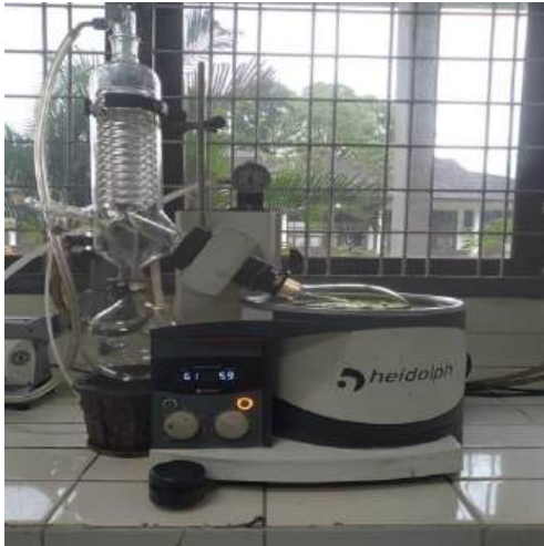
Proses Pengentalan dan Pemekatan Ekstrak Daun Murbei Di Rotary Evaporator
