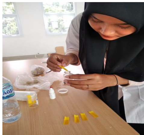
Gambar (5) Mencelupkan kertas uji pada cairan
