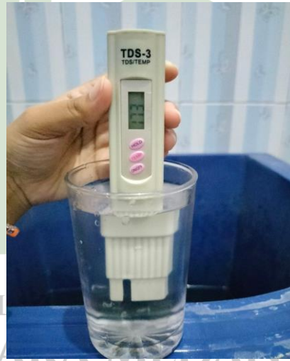
Gambar 3. Pengukuran TDS pada sampel air sumur
