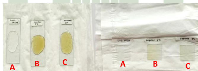
Gambar 4.7 Hasil Ujian Homogenitas Sediaan, keterangan: Sediaan Masker Tanpa Ekstrak (a), masker gel ekstrak daun saga 7% (b), masker gel ekstrak daun saga 9%. Masker gel ekstrak daun saga 9% (c).
