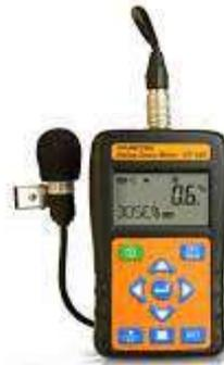
Gambar 2.4 Noise Dosimeter
