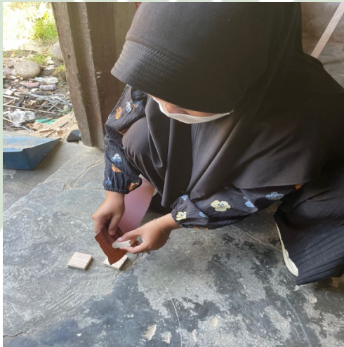
Gambar 2.3 Merapikan Sisi Potongan Kayu Triplek
