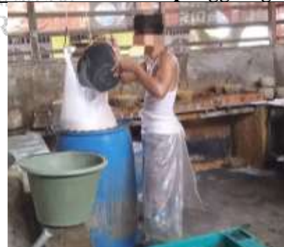
Pekerja melakukan penyaringan bubur kedelai yang sudah dimasak untuk mendapatkan sari kedelai
