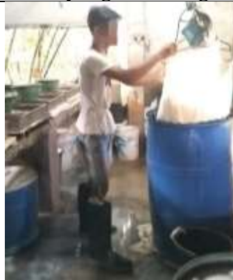
Pekerja melakukan penyaringan bubur kedelai yang sudah dimasak untuk mendapatkan sari kedelai
