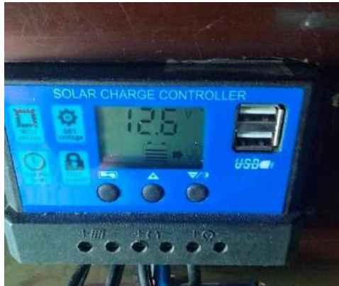
Nilai Tegangan Panel Surya yang Tampil Pada display SCC
