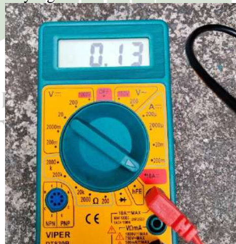
Nilai Arus yang Terukur Pada Multimeter
