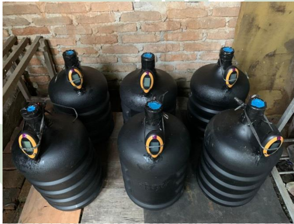
Gambar 2.1 Rancangan digester biogas
