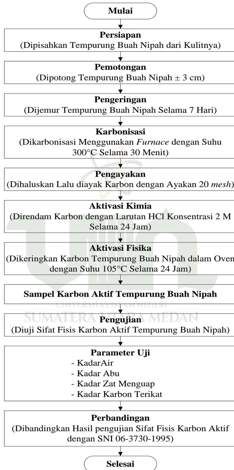
Gambar 3.1. Diagram Alir Pembuatan dan Pengujian Karbon Aktif Tempurung Buah Nipah
