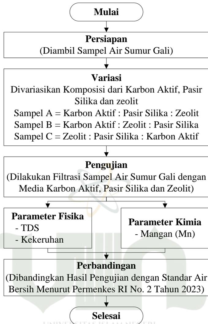
Gambar 3.3. Diagram Alir Penelitian dan Pengujian Kualitas Air Sumur Gali dengan Media Filtrasi Karbon Aktif Tempurung Buah Nipah, Pasir Silika dan Zeolit
