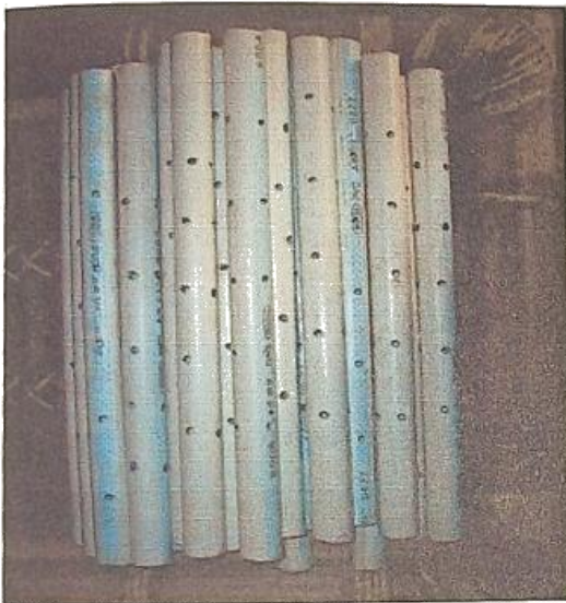
Gbr. Pipa paralon utk memasukkan air ke perakaran
