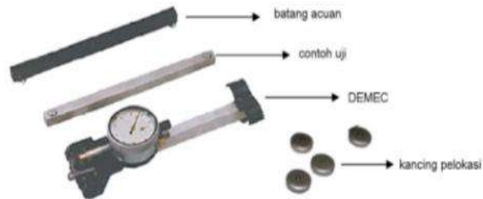
Gambar 1 – alat ukur Demountable mechanical (DEMEC) dan kancing pelokasi
