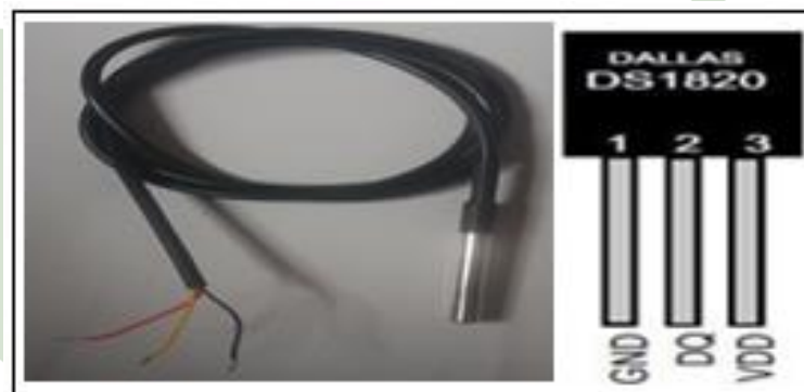
Gambar 2.7 Bentuk fisik dan keterangan pin IC sensor DS18B20
