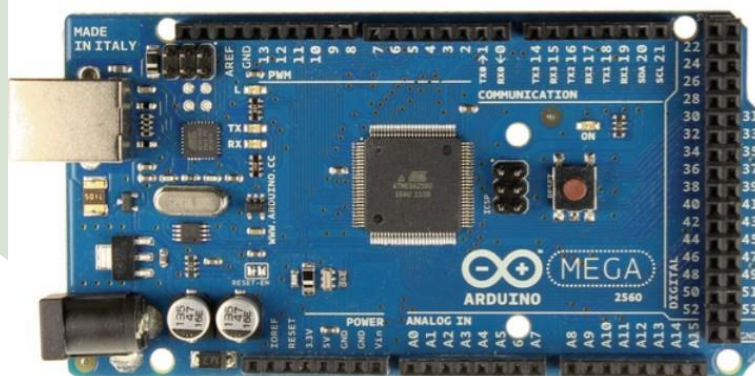
Gambar 2.4 Bentuk Fisik Arduino Mega 2560
