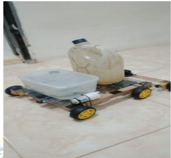
Gambar 2. Pengujian Beban 4.5 Liter
