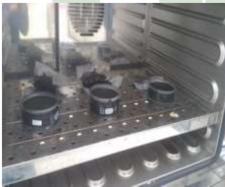
Dikeringkan menggunakan oven dengan suhu 110^{\circ}C
