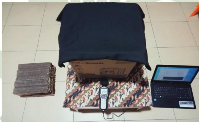
Gambar 4.9 Proses Pengujian Koefisien Serap Bunyi ( \alpha )
