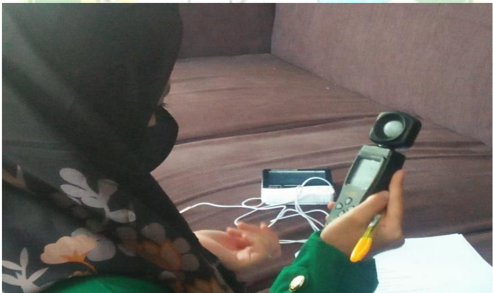
Gambar 2. Observasi pengukuran pencahayaan dengan menggunakan alat lux meter pada rumah penduduk pada lokasi penelitian di wilayah tempat pembuangan akhir sampah (TPA) Terjun Kecamatan Medan Marelan
