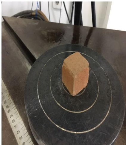
3. Pengujian kuat Tekan
