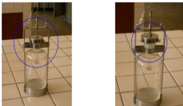
Gambar 2 Contoh alat pengambil contoh air sumur gali
