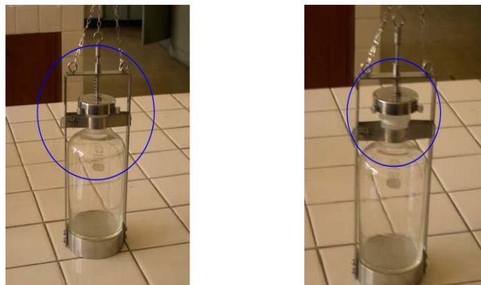
Gambar 2 Contoh alat pengambil contoh air sumur gali
