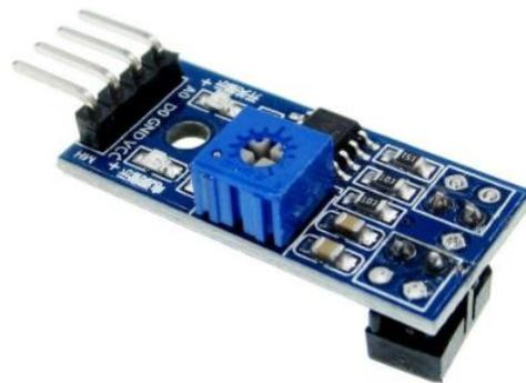
Gambar 2. 16 Module Sensor *Infrared* TCRT5000
