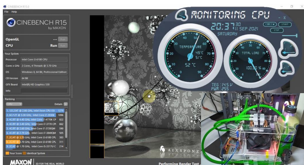
Gambar 4. 15 Uji benchmark menggunakan Cinebench R15 pada water cooling peltier dengan logika fuzzy
