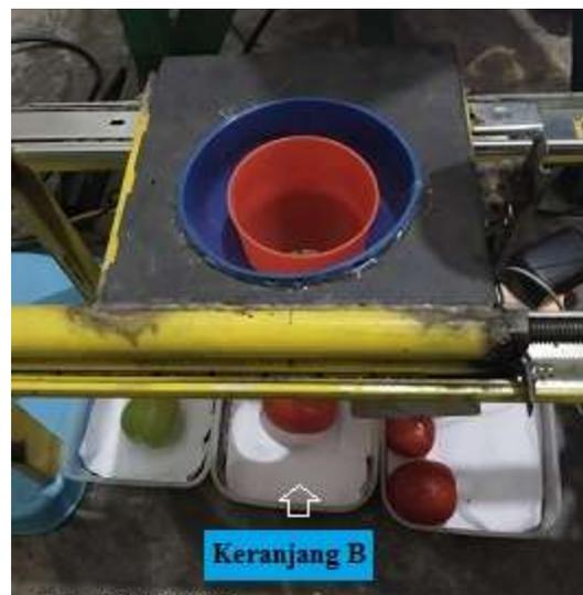
Gambar 4.25 Hasil Pengujian Buah Tomat Setengah Matang
