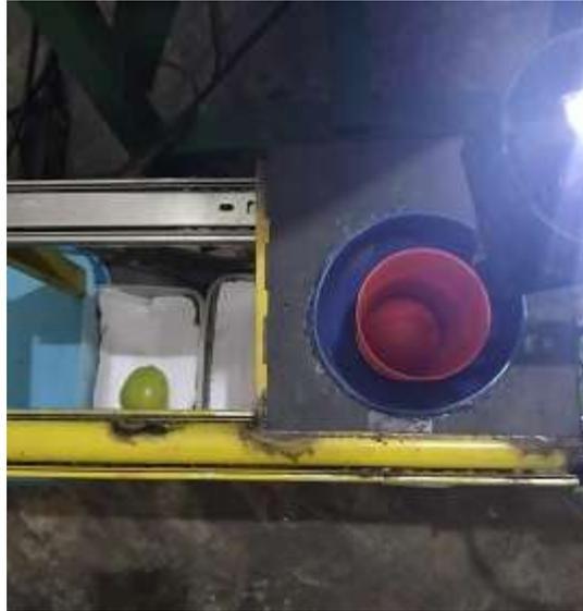
Gambar 4.24 Buah Tomat Dimasukkan Kedalam Penampung Konveyor
