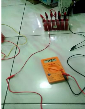
Pengukuran tegangan listrik tanpa LED biobaterai larutan sari buah tomat
