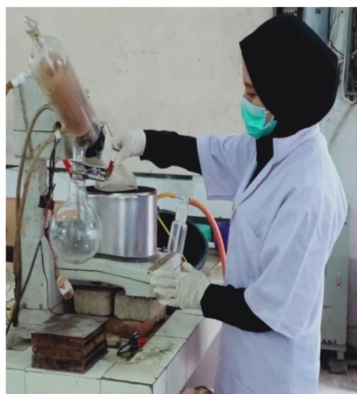
Gambar 4. Pengentalan ekstrak umbi lobak putih menggunakan *Rotary evaporator*
