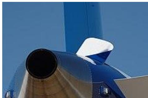
Gambar 2.7 APU knalpot ekor pada pesawat, dengan panel asupan terbuka
