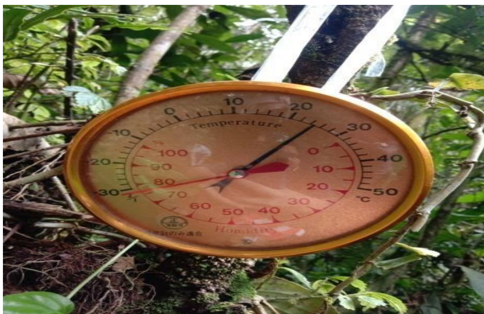
Pengukuran suhu dan kelembaban udara menggunakan Thermohygrometer
