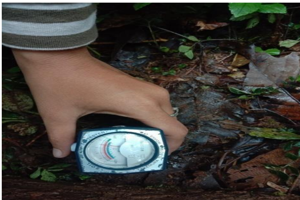
Pengukuran Ph tanah menggunakan Soiltester
