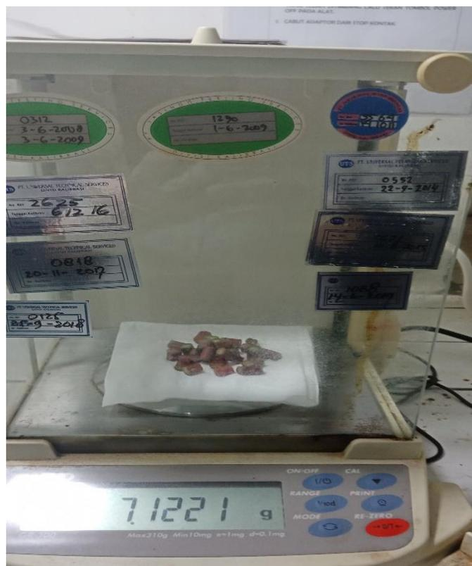
Batang nampu ditimbang menggunakan timbangan digital sebanyak 7 gr
