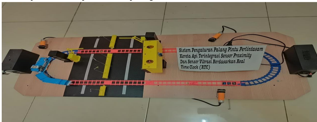
Gambar 4.1. Miniatur Palang Pintu Kereta Api Otomatis
