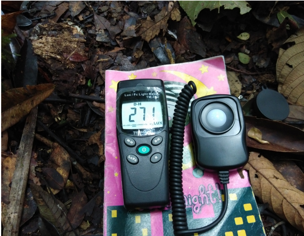
Gambar Pengukuran Intensitas Cahaya ( Lux Meter )
