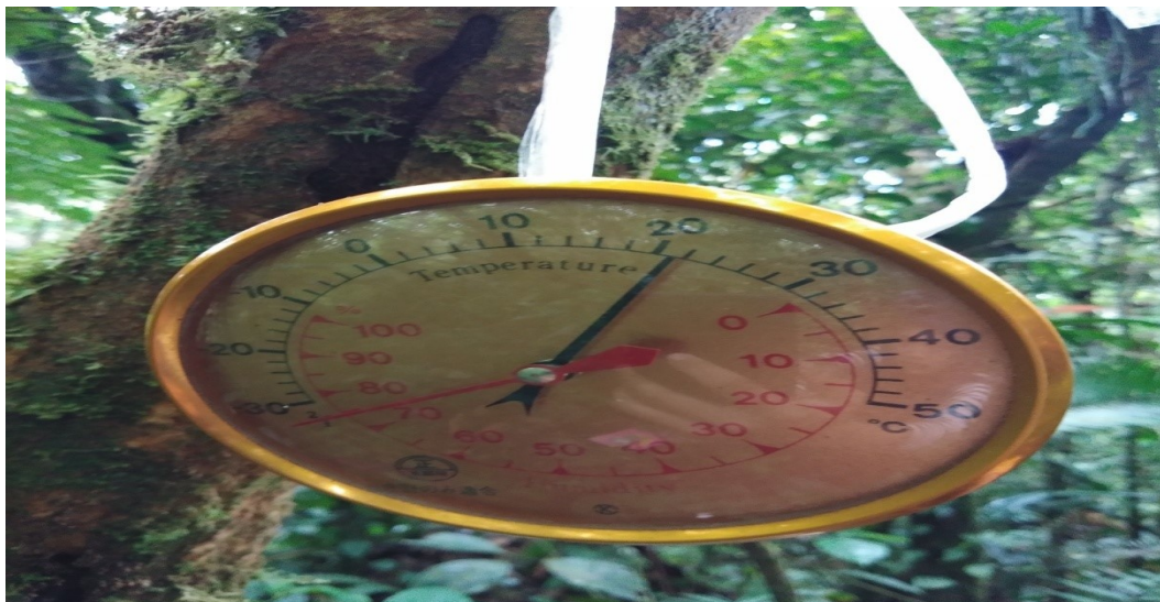
Gambar Pengukuran Suhu Dan Kelembaban ( Termohygrometer )
