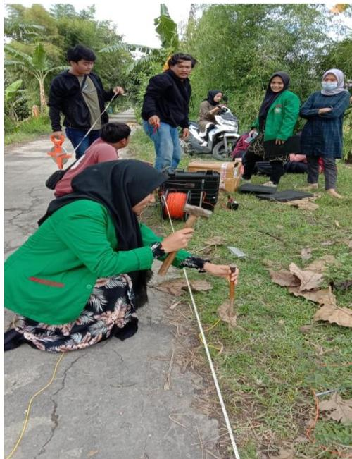
3. Menentukan nilai arus dan tegangan menggunakan *resistivity meter*
