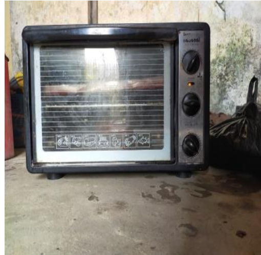
2. Proses Karbonisasi batang pohon teh pada suhu 200°C selama 3 jam
