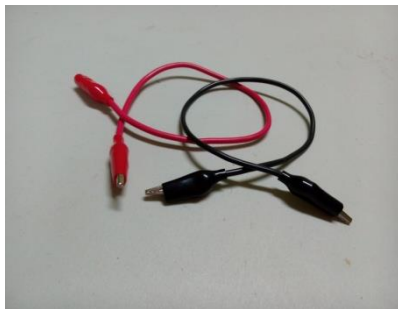
Gambar Kabel Penghubung
