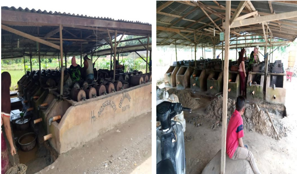
Gambar 5: Proses pengolahan batuan emas (gelundung) yang sedang beroperasi
