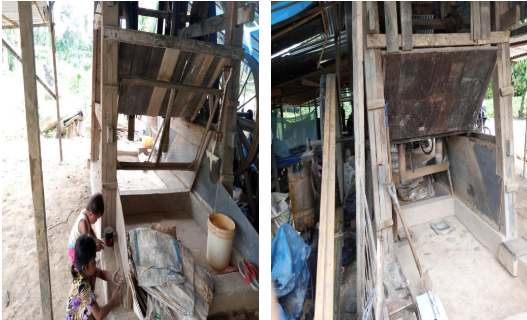
Gambar 6: Mesin penumbukan batu apabila kurang halus sewaktu di proses dengan manual
